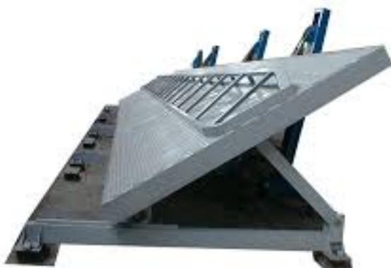
Автомобилеразгрузчик АВС-50М предназначен для механизированной выгрузки сыпучих грузов из грузовых автомобилей, а также из автопоездов с одним или несколькими прицепами без их расцепки.
